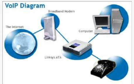
SIP නියමාවලිය භාවිතයේ දී P2P (peer to peer) හෙවත් සම-සම සන්නිවේදනය සම්බන්ධතාවක් භාවිතා කෙරේ. SIP සේවා දායකය (server) මගින් සම්බන්ධතාවය මුලින් ඇති කිරීම කරනු ලබයි. සම්බන්ධතාවය ඇති කළ පසු සම්බන්ධතාවය ඇති කළ පත්‍ර දෙක අතර, සෘජුව සන්නිවේදනය P2P සම්බන්ධතාවයක් (SIP) සේවාදායක සර්වරය හරහා නොමැතිවමගින් සිදු කෙරේ.
