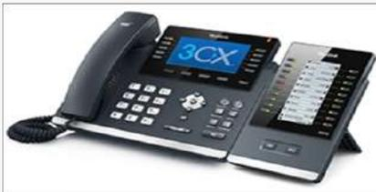
මෙම වර්ගයේ SIP දුරකතනයක් පුළුල් කලාපීය රවුටරයකට (broadband router) සම්බන්ධ කෙරේ. එසේ නැතහොත් (SIP ATA(Analogue Telephone Adaptor) වශයෙන් දැක්වෙන ඇනලොග් දුරකථන ඇඩැප්ටරයක් රවුටරයකට සම්බන්ධකර එයට සාමාන්‍ය දුරකථනයක් සම්බන්ධ කෙරේ. අන්තර්ජාල පහසුකම් සහිත පුළුල් කලාපීය රවුටරයක් තිබීම මෙවන් දෘඩාංග SIP දුරකථන සඳහා අවශ්‍යතාවකි. මෙවන් දුරකථනයක් භාවිතයේ දී පරිගණකයක් අවශ්‍යය නොවේ.
